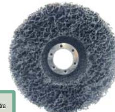
Disco realizzato con una **speciale combinazione di fibre sintetiche e abrasive ideale per satinatura e finitura satinata di superfici**. Rimozione di calamina, ossidi, vernici, ruggini, cere e altri materiali intasanti. La struttura aperta impedisce l'intasamento e consente una smerigliatura fredda.
