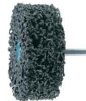
Mola Policlean con gambo, in abrasivo per pulitura (Vlies) a struttura grossolana realizzato con una speciale combinazione di fibre sintetiche e abrasive. La struttura aperta impedisce l'intasamento e consente una smerigliatura fredda, si adatta in modo ideale ai contorni e alla superficie del pezzo da lavorare.
