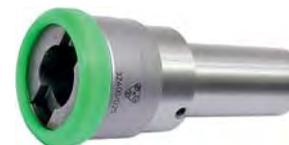
Maschiatore attacco cilindrico DIN 1835 B+E per bussole di maschiatura con o senza frizione a cambio rapido, **compensazione assiale** in compressione assiale e trazione. Adatto per torni a controllo numerico.
