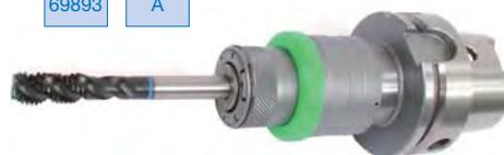
Maschiatore attacco HSK-A DIN 69893 per bussole di maschiatura con o senza frizione a cambio rapido, **compensazione assiale** in compressione e trazione. Adatto per centri di lavoro e macchine programmate.
