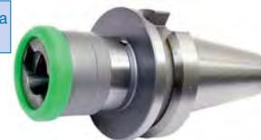
Maschiatore attacco MAS-BT JIS B 6339 A per bussole di maschiatura con o senza frizione a cambio rapido, **compensazione assiale** in compressione e trazione. Adatto per alesatrici e centri di lavoro.
