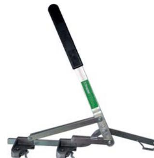
Tenditore per funi composto da un telaio guida, sul quale si articolano una leva e due ganasce a camma autoserrante. Ad ogni movimento della leva le ganasce si spostano simmetricamente sulla guida, mentre una tira la fune l'altra torna liberamente indietro. Ideale per la tesatura di funi metalliche e di reti di protezione.
