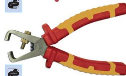
**N32812** - Pinze spellafili, UNI 7923, in acciaio al cromo vanadio, **esecuzione cromata lucida**, con vite per la regolazione della profondità di spellatura e molla di riapertura della testa, impugnature ergonomiche bimateriali VDE, **conformi alla norma europea EN 60900**, per utilizzo in circuiti sotto tensione **fino a 1000V** in corrente alternata.
