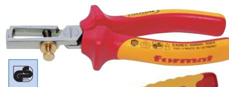
**N32050** - Pinze spellafili VDE DIN 5743, in acciaio speciale per utensili, temprato e rinvenuto in olio, testa cromata, semplice regolazione tramite vite a testa zigrinata e controdado, con molla di apertura, impugnature in materiale plastico multicomponente, per l'utilizzo in circuiti sotto tensione **fino a 1000 V**, **secondo IEC 60900, DIN EN 60900, VDE 0682 / Parte 201**.
