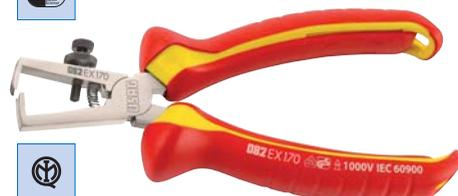
**N35459** - Pinze spellafili, in acciaio speciale forgiato, **esecuzione cromata lucida**, con vite per la regolazione della profondità di spellatura e molla di riapertura della testa, impugnature ergonomiche bimateriali VDE, **conformi alla norma europea EN 60900**, per utilizzo in circuiti sotto tensione **fino a 1000V** in corrente alternata.
