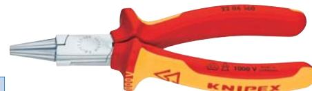
Pinze a becchi tondi corti **con superficie di presa liscia**, DIN ISO 5745, in acciaio al cromo vanadio, **esecuzione cromata lucida**, impugnature ergonomiche bimateriali VDE, **conformi alla norma europea EN 60900**, per utilizzo in circuiti sotto tensione **fino a 1000V** in corrente alternata.
