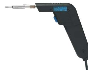
Saldatore rapido a pistola estremamente leggero, con punta di saldatura in Ersadur a forma di scalpello 3,2 mm, la punta interna riscaldata in combinazione con l'elemento riscaldante PTC garantisce un'eccellente efficienza con il minimo consumo di energia, regolazione istantanea della temperatura esclusivamente tramite pressione del pulsante.
