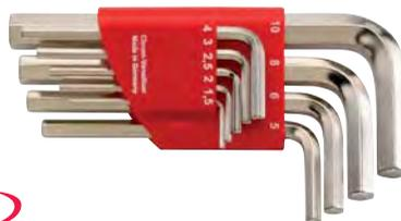
**N20 848** - Serie di chiavi maschio esagonali piegate UNI ISO 2936 DIN 911, in acciaio al cromo vanadio, esecuzione nichelata, verniciatura con colore differenziato per ogni misura, estremità piane e smussate.
